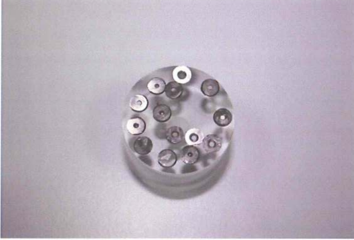
Şekil 3.2: Örneklerin akrilik silindir kalıp içerisine gömülmesi ( Cito Press-10 Struers Ltd, Lanarkshire, İngiltere )
