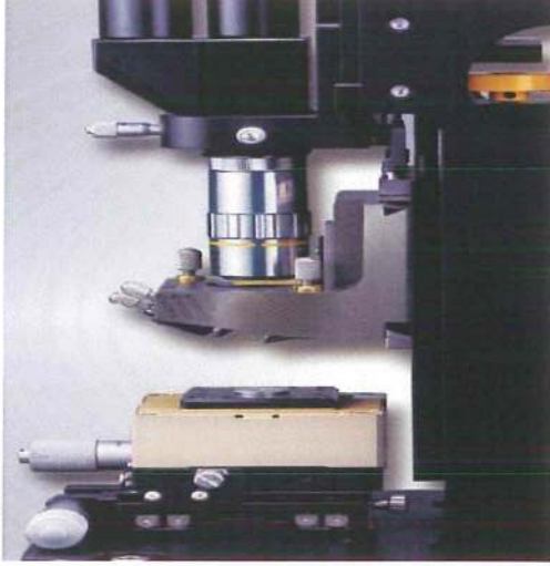
Şekil 3.6: AKM cihazı ( XE-100 AFM, PSIA Corp., Korea )
