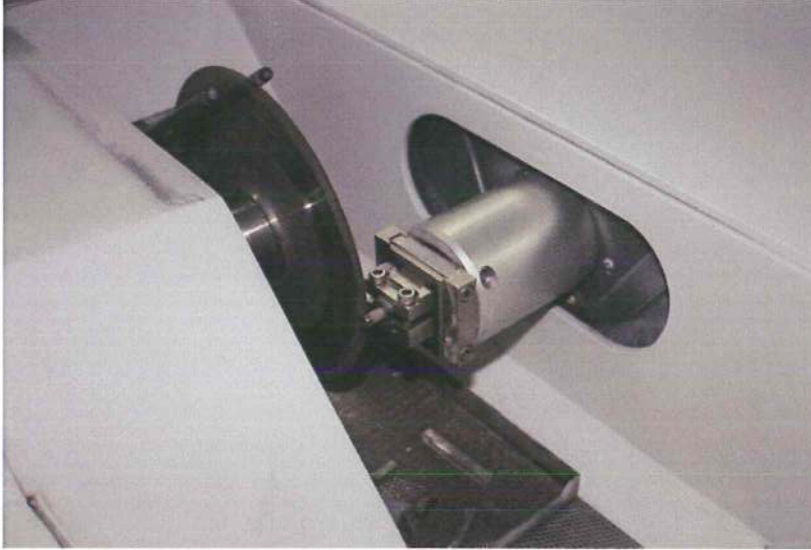
Şekil 3.1: Kesme cihazı ( Accutom-50, Struers Ltd, Lanarkshire, İngiltere )
