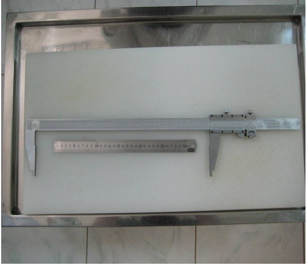
Şekil 3.8. Kemik ölçümünde kullanılan çelik cetvel ve ekstremite uzunluk ölçümlerinde kullanılan verniye kumpası.
