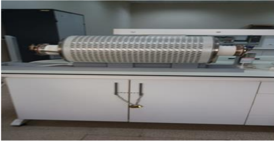
Şekil 3.2. Fırının yatay durumu.
