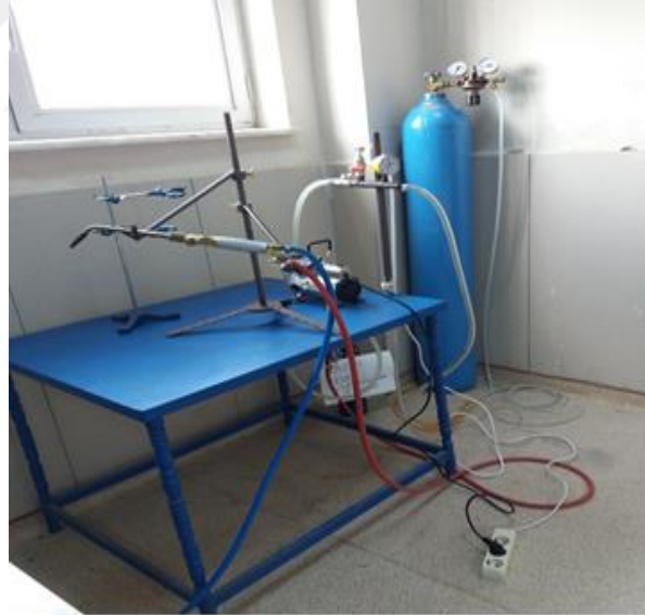
Şekil 3.4. Kuvars tüp içerisinde vakum yaratmak için vakum sistemi ve kuvars tüp kapatma düzeneği.
