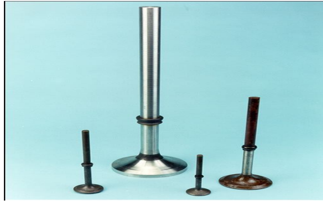
Şekil 3.45. Sürtünme kaynağı ile imal edilmiş egzoz supapları (mtiwelding.com).
