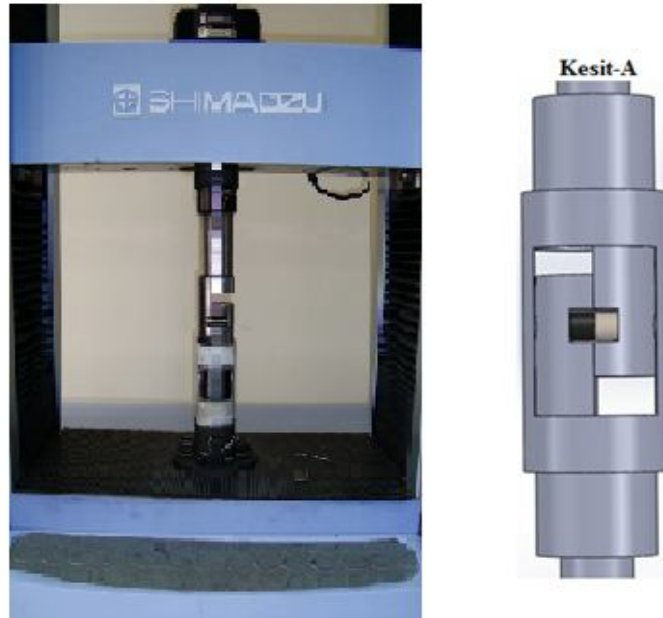
Şekil 4.18. Bindirme kayma aparatı şematik resmi
