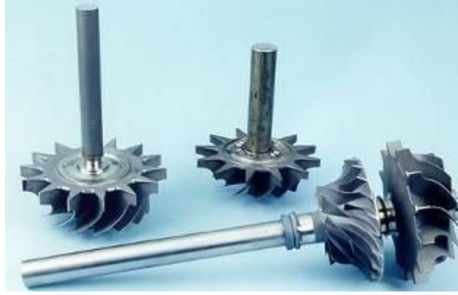
Şekil 3.46. Sürtünme Kaynağı ile imal edilmiş uçak parçası (mtiwelding.com)
