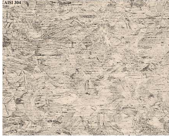
Şekil 5.20 Ostenitik paslanmaz çeliğin SEM mikroyapı fotoğrafı
