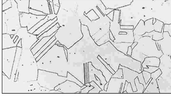
Şekil 3.34. Östenitik paslanmaz çeliğin mikroyapısı (Aran, vd., 2003).
