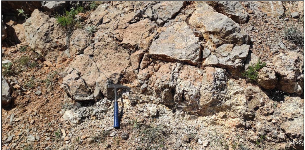
Şekil 3.3.2.5.a: Keltepe'de fay düzlemi üzerinde ezik- breşik zonun görüntüsü
