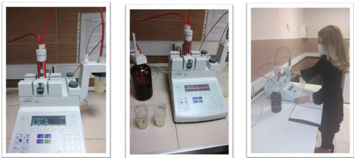
Şekil 3.7. Mettler Toledo D150 Graphix cihazı ve Toplam asitlik ve pH ölçümü
