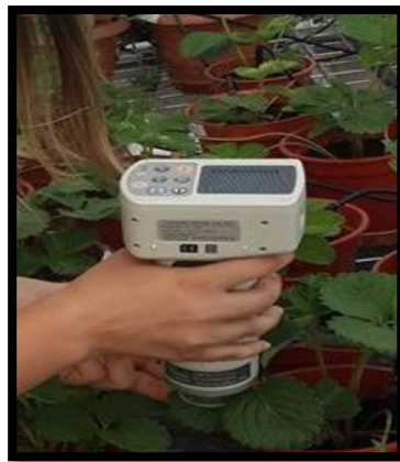
Şekil 3.18. L, a, b değerlerinin belirlenmesine yönelik kurulan denemede çilek yapraklarında renk ölçer ile yapılan ölçümler
