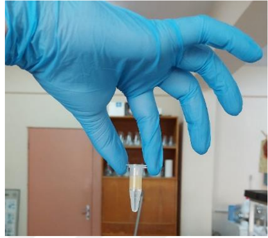
Santrifüjleme sonucun tüplerde 2 faz oluşumu
