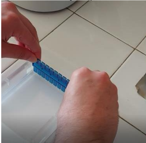
Donmuş agorozdan tarğın çıkarılması
