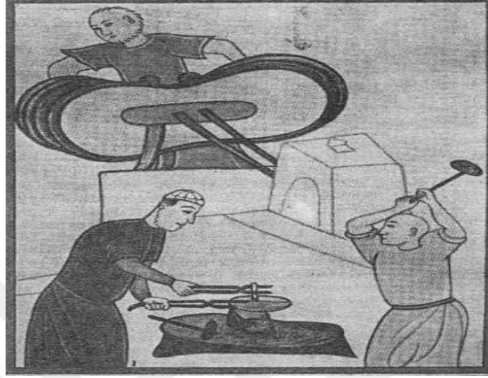
Şekil 1.2: Çekiç Darp Tekniği İle Sikke Basımı
