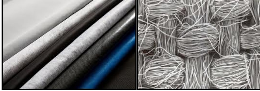
Şekil 2.11 : Aktif karbon kumaş ve dokuma kumaştan geliştirilen aktif karbonun SEM görüntüsü (Calgon Carbon) ( www.chemvironcarbon.com , Url-3).
