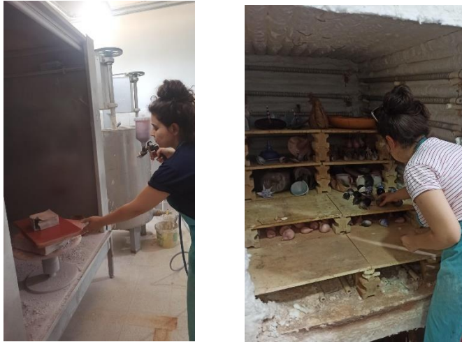
Görsel 3.43: Püskürtme yöntemi ile sırlama
