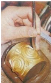
Resim 2.14. Kabartma tekniği (Savaşçın ve Türe, 2000:31)
