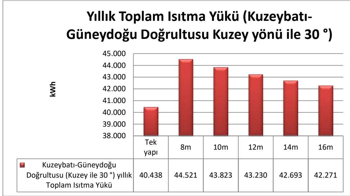
Şekil 4.68. Kuzeybatı-güneydoğu (kuzey yönü ile 30 °)doğrultusunda farklı mesafelerde yerleştirilmiş Engellerin oluşturduğu gölge etkisine bağlı yıllık toplam ısıtma yük değişimleri
