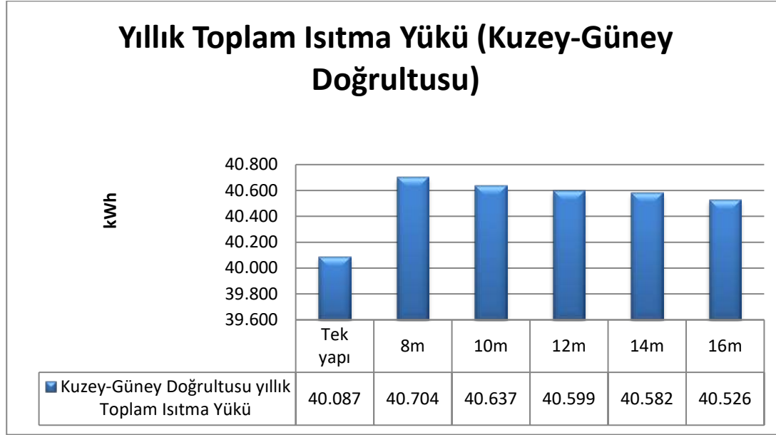
Şekil 4.44. Kuzey-güney doğrultusunda farklı mesafelerde yerleştirilmiş engellerin oluşturduğu gölge etkisine bağlı yıllık toplam ısıtma yük değişimleri
