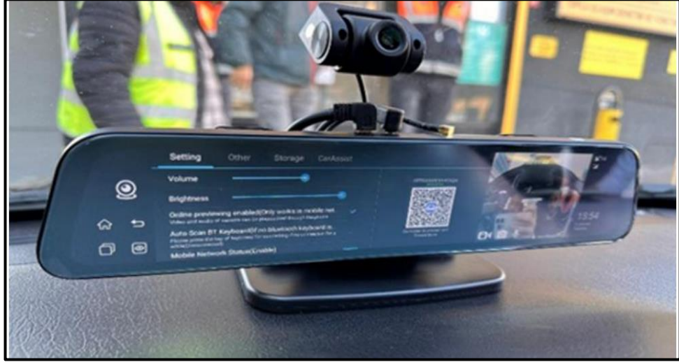
Şekil 5-4: Araç İçi Kamera ve GPS Anteni Montajı
