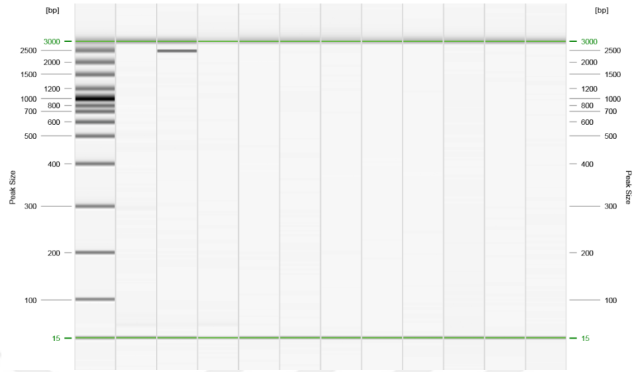
Şekil 4.22. Fosfat çözme (+) özellikli test bakterilerinin PqqB2F/PqqB2R primer seti ile yapılan PCR uygulamalarının amplifikasyon sonuçları
