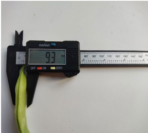
Şekil 3.16. Kumpas yardımıyla bakla eti kalınlığının ölçümü
