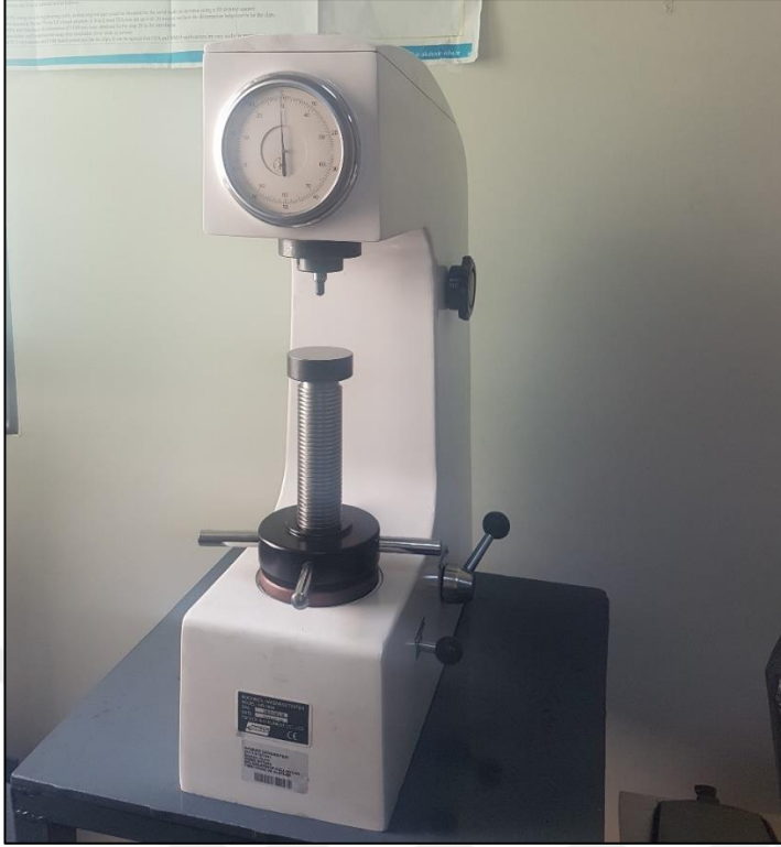
Şekil 3.17. Sertlik ölçüm deneyinde kullanılan Rockwell sertlik ölçüm cihazı
