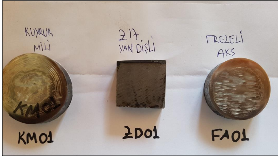
Şekil 3.12. Kimyasal analiz için hazırlanan numuneler
