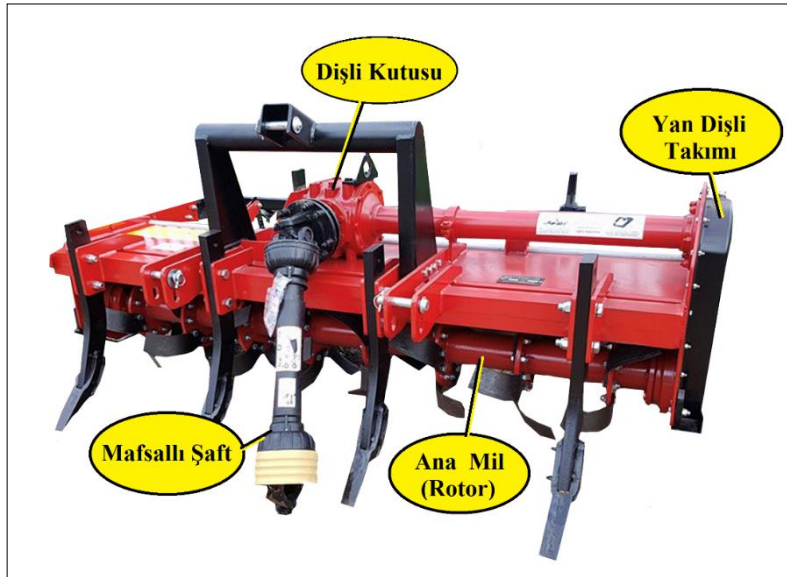
Şekil 3.1. Toprak frezesinin hareket iletim sistemleri
