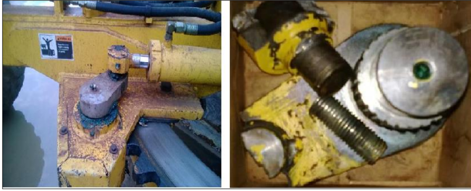
Şekil 2.5. Hasarlı daire dişli rotu ve bulunduğu konumu
