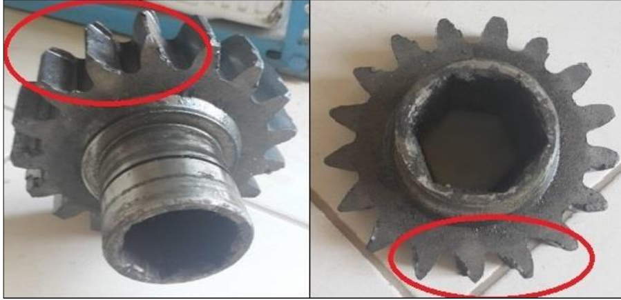
Şekil 3.8. Hasarlı Z17 dişlisinin görünümü
