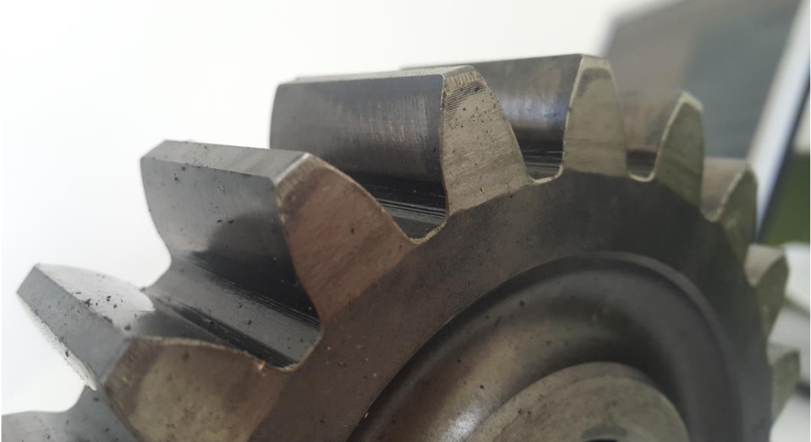
Şekil 4.20 Test sonrası Vites dişlisi görüntüsü.
