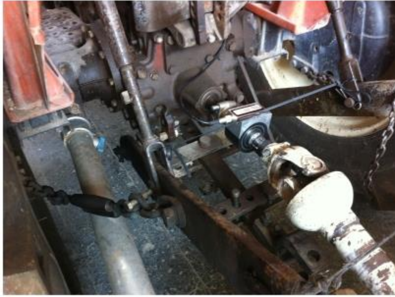
Şekil 3.12 Torkmetre traktör bağlantısı görünümü.
