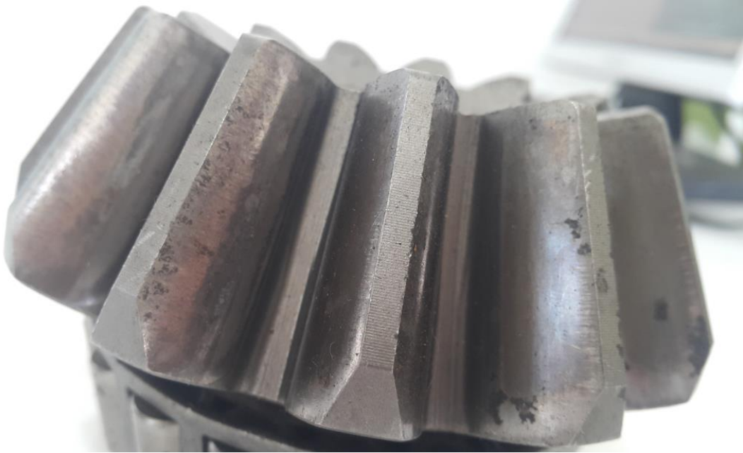
Şekil 4.18 Test Sonrası Pinyon dişli görüntüsü.
