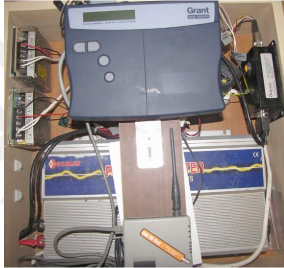
Şekil 3.2 Data logger ve elektronik ölçüm seti.
