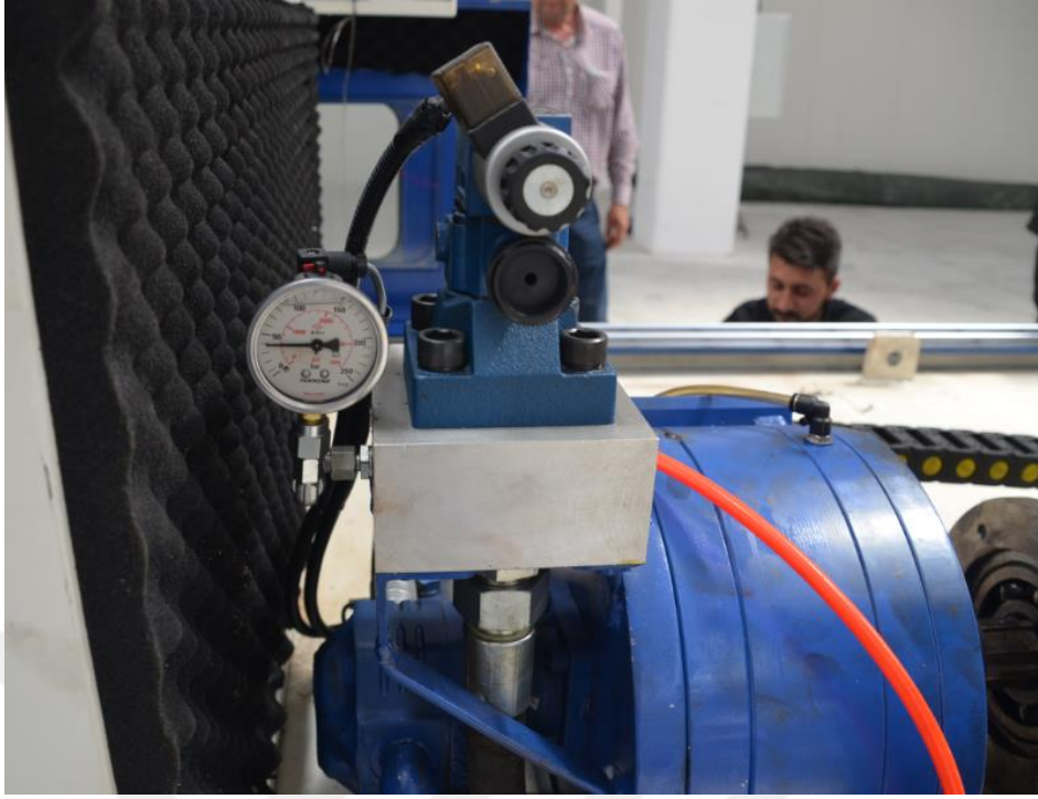
Şekil 3.17 Planet dişli sistemine bağlı Hidrolik Pompa ve kısma valfi.
