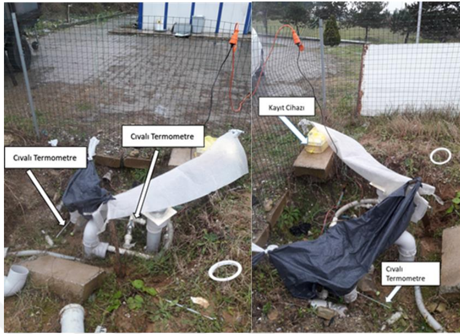
Şekil 4.5. Cıvalı Termometrelerin PVC Borulara Yerleşimi ve Termokupl Cihazı
