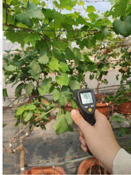
Şekil 3.23. Infrared termometre ile yaprak sıcaklığının ölçülmesi
