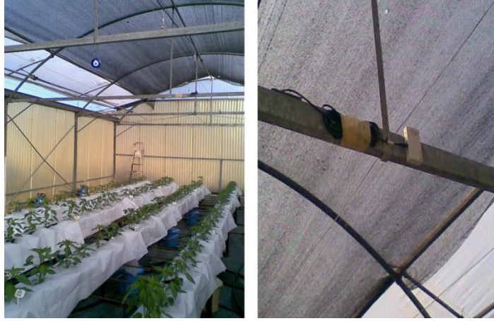
Şekil 3.3. Sera iç gölgelemesinin ve iklim parametrelerini ölçen (sıcaklık ve nem) iklim istasyonunun genel görünümü.
