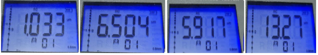
Şekil 5.13: Titreşim söndürücü kütle-yay eklenmemiş proseslerde yüzey pürüzlülüğü ölçümü (Ra - \mu\text{m} ) (a: 600 dev/dak, b: 8000 dev/dak, c: 1000 dev/dak, d: 1200 dev/dak)
