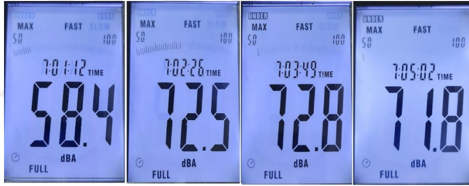
Şekil 5.7: Titreşim söndürücü kütle-yay eklenmemiş proseslerde ses seviyesi ölçümü (dB)
