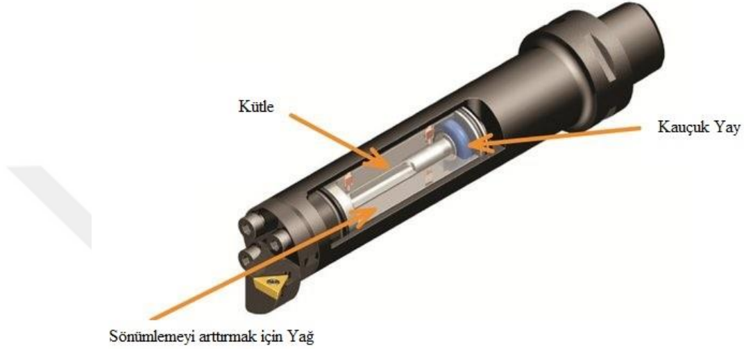
Şekil 1.2: Sandvik firmasının anti-vibrasyon takım tasarımı
