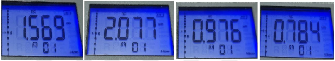
Şekil 5.14: Titreşim söndürücü kütle-yay eklenmiş proseslerde yüzey pürüzlülüğü ölçümü (Ra - \mu\text{m} ) (a: 600 dev/dak, b: 8000 dev/dak, c: 1000 dev/dak, d: 1200 dev/dak)
