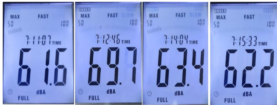
Şekil 5.8: Titreşim söndürücü kütle-yay eklenmiş proseslerde ses seviyesi ölçümü (dB)
