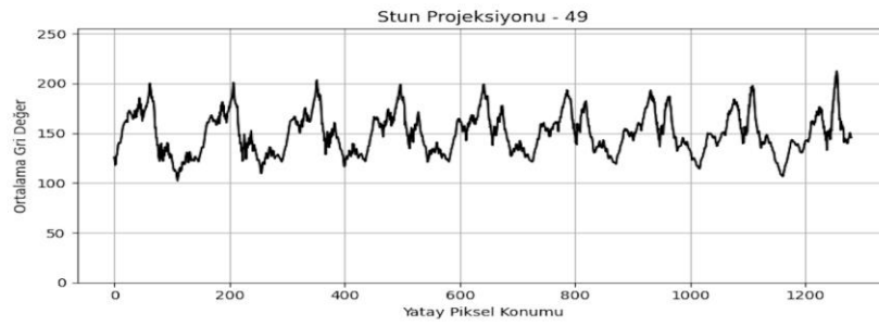
Şekil 17. Az aşınmış ve aşınmış takım ile işlenmiş yüzeylerden elde edilen iki gri tonlamalı video karesinin sütun projeksiyonları karşılaştırılması.
