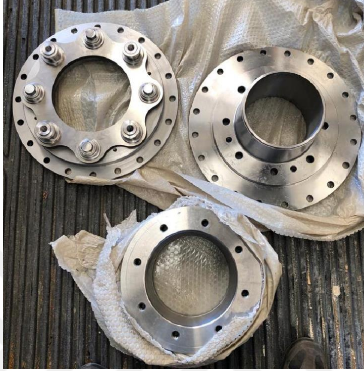
EK 1.Yerli Olarak Üretilen Torsiyonel Rijit Fan Kaplin
