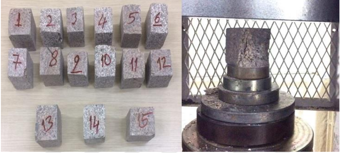
Şekil 2.6. Araziden alınan örneklerin tek eksenli sıkışma dayanım testi
