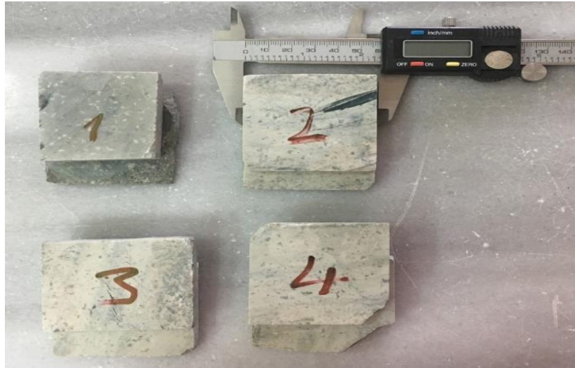
Şekil 3.17. Dasitlere ait makaslama deneyi örnekleri
