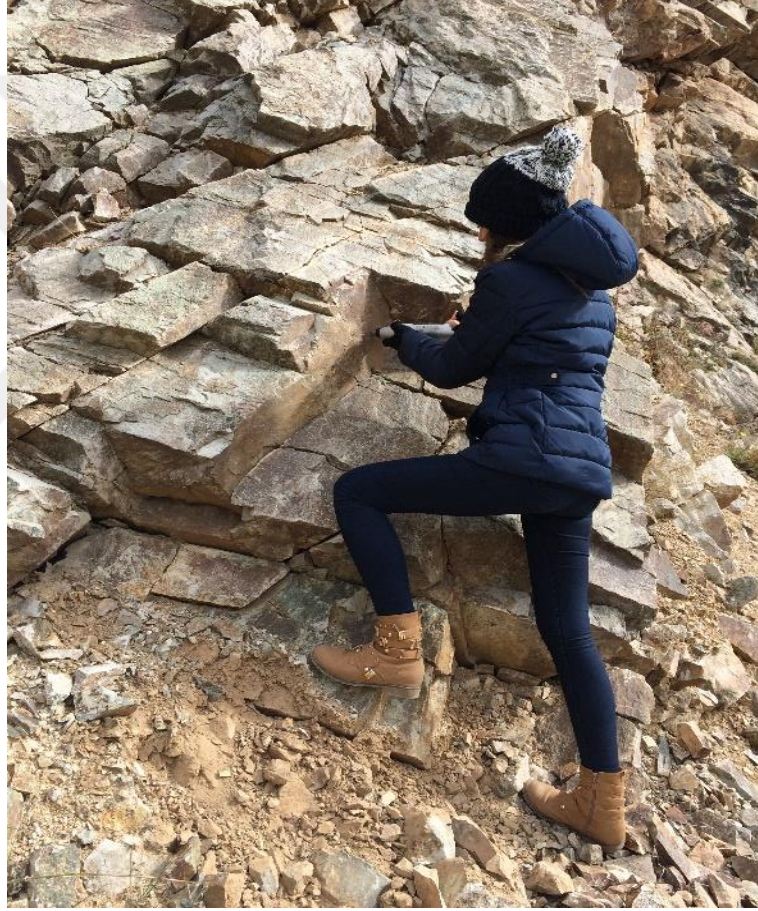
Şekil 2.5. Arazide sürekliksizlik yüzeylelerinde Schmidt çekici deneyi
