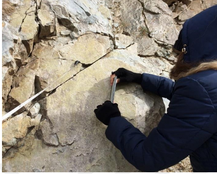
Şekil 2.3. Şev süreksizliklerinden alınan pürüzlülük ölçümü
