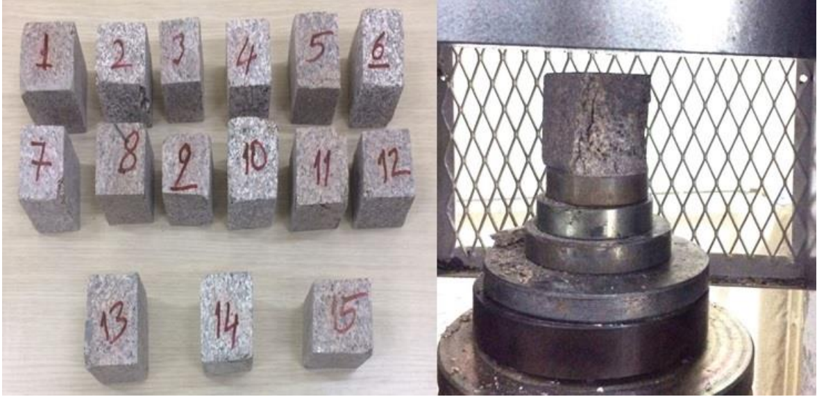
Şekil 3.22. Sarıosman Monzograniti'ne ait örnekler ve tek eksenli sıkışma dayanım deneyi
