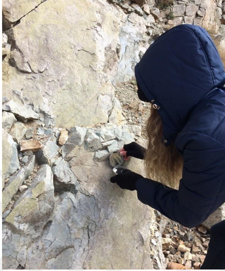
Şekil 3.7. Süreksizlik yönelimlerinin pusula ile ölçümü
