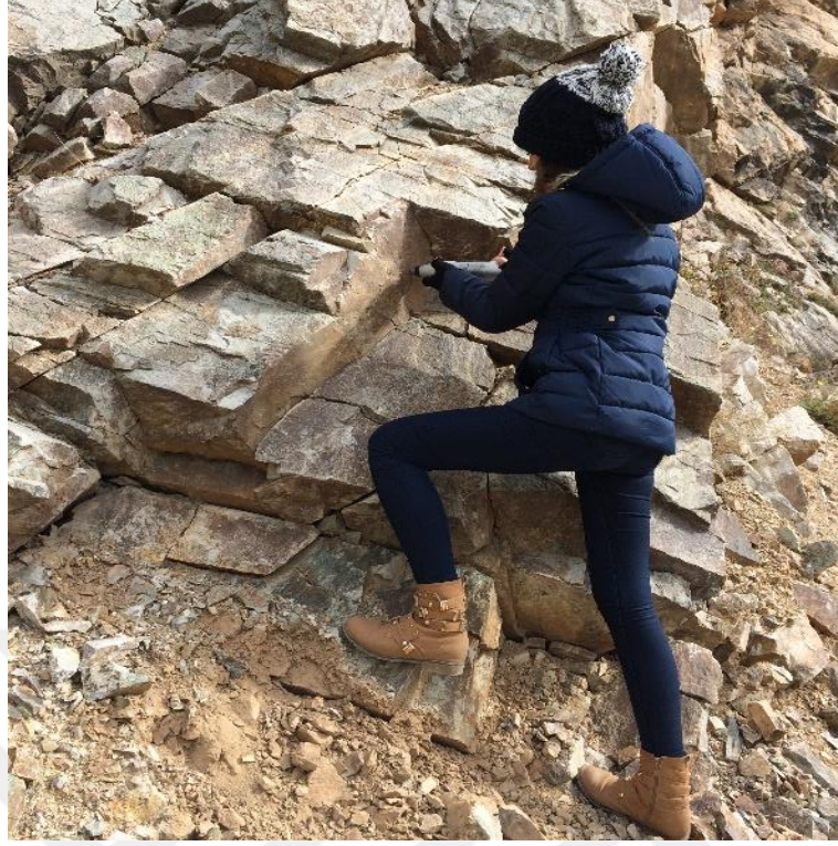
Şekil 3.15. Süreksizlik yüzeylerinde Schmidt çekici deneyi
