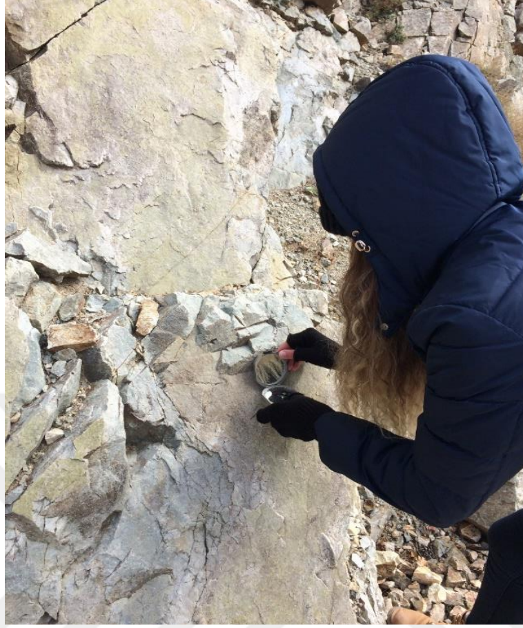
Şekil 2.2. Süreksizlik yönelimlerinin pusula ile ölçümü
