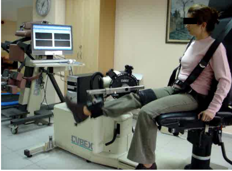
Resim 2: Cybex NORM izokinetik dinamometre (Lumex Inc, Ronkonkoma, NY)
