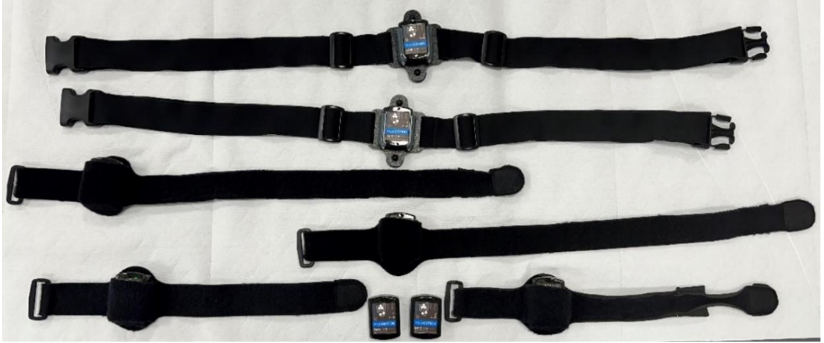
Şekil-8: Giyilebilir sensörler (IMU) ve giyme aparatları.
