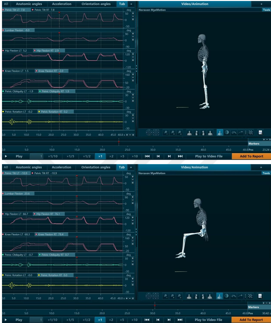
Şekil-13: Oturma analizi sırasındaki 'Noraxon® myoMETRICS' ölçümleri.
