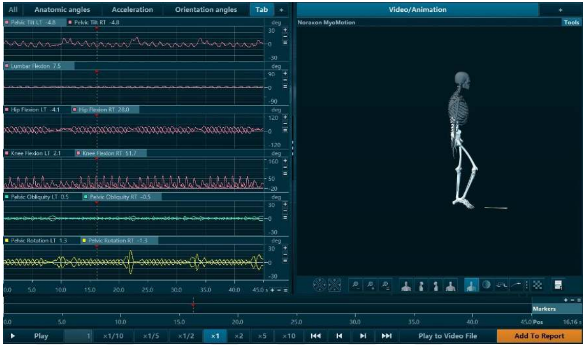
Şekil-11: Yürüme analizi sırasında 'Noraxon® myoMETRICS' ölçümleri.
