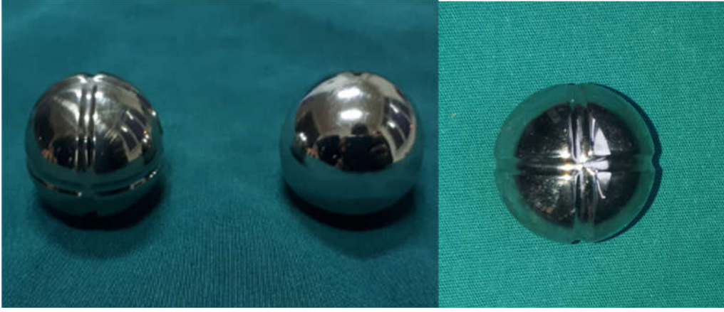
Şekil 8. Yüzey geometrisi değiştirilmiş oluklu femoral baş ve standart femoral baş
