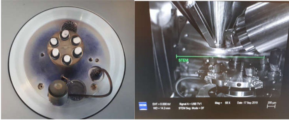
Şekil 22. Linerların elektron mikroskopik inceleme için palladium ile kaplanması ve elektron mikroskop içindeki görüntüsü
