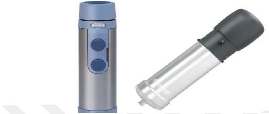
Şekil 2.6. Boyun Tipi Elektronik Larinks (11).
