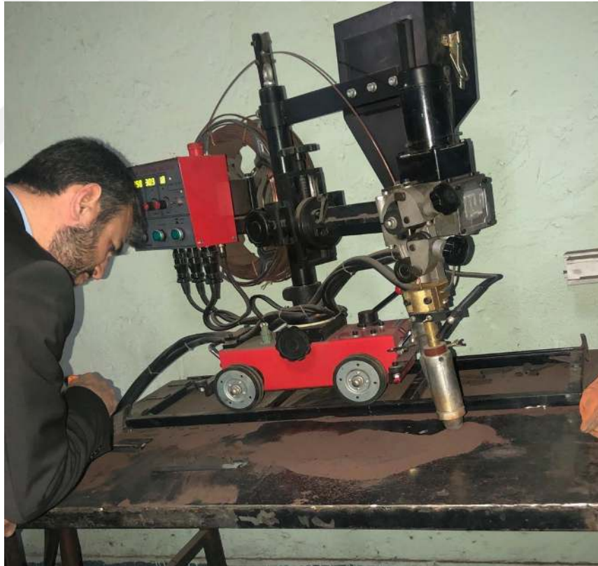
Şekil 1.10.Tozaltı kaynak yöntemi ve cihazın görünüşü
