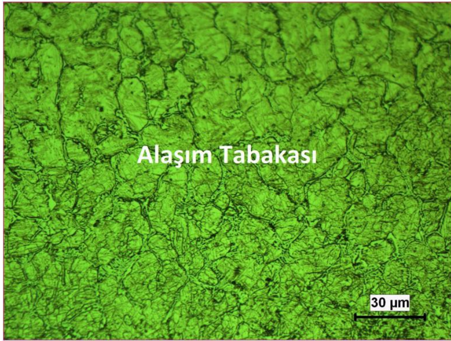
řekil 3.24. B6 numunesinin optik fotoğrafı, a) Alařım tabakası ve altlık malzemeye ara yüzeyi, b) alařım tabakası
