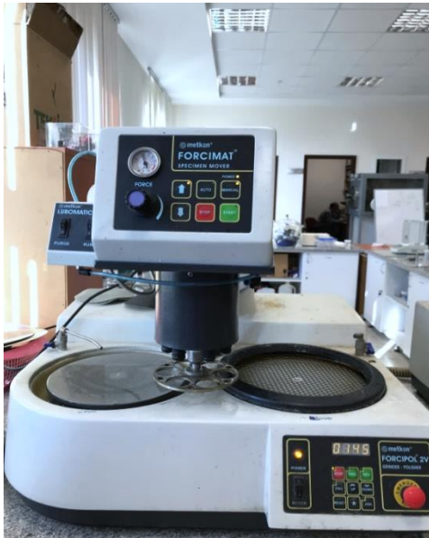
Şekil 3.11. Döner tablalı zımparalama makinesi
