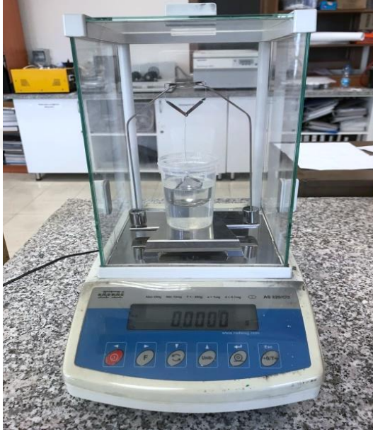
Şekil 3.7. Arşimet yöntemi ile yoğunluk ölçümü mekanizması
