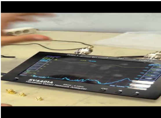
Şekil 3.1.6 NanoVNA SV4401A 50KHz-4400MHz model vektör ağ analizörü
