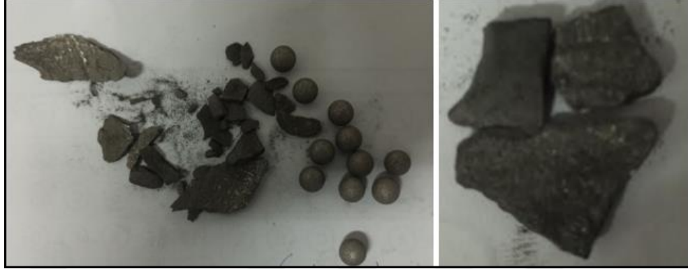
Şekil 3.2. 600 dakika öğütme işleminden sonra elde edilen toz yapısı
