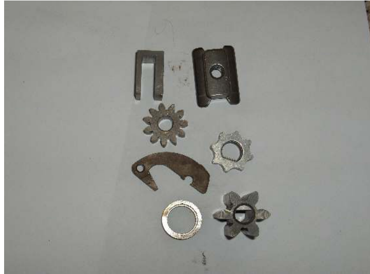
Şekil 2.12. Toz metalurjisi teknięi ile üretimi yapılan bazı ürünlerin fotoęrafları.
