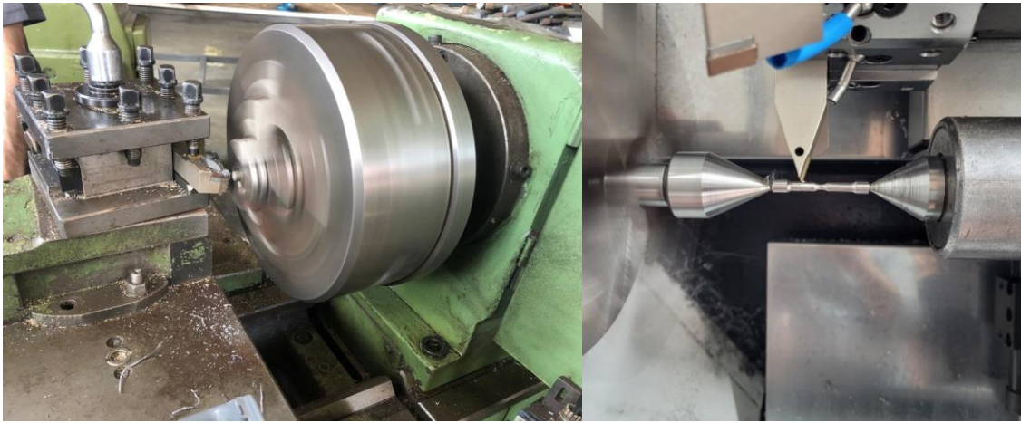
Şekil 4.14 EOS M290 cihazından çıkan numunelerin CNC ve Torna tezgahında talaşlı imalat aşamaları
