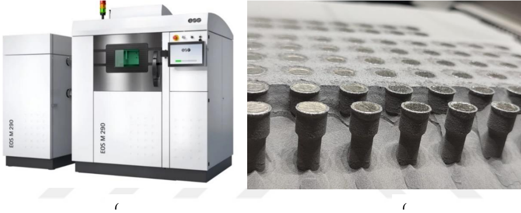
Şekil 4.12 a) Ti6Al4V numunelerinin üretildiği 3D baskı cihazı b) Isıl işleme tabi tutulmamış, işlenmemiş Ti6Al4V alaşımı
