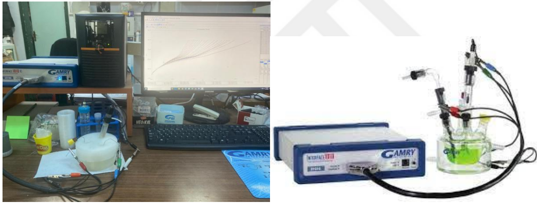
řekil 9.8. Gamry marka Interface 1010E potansiyostat/galvanostat cihazı,  elektrotlu elektrokimyasal hcre ve analizlerin gerekleřtirildięi bilgisayar
