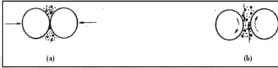
Şekil 3.9. Atritör değirmende öğütülme esnasındaki hareketler, (a) darbe, (b) kesme
