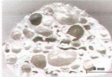
Resim 5.1. %0.5 TiH 2 ilave edilerek elde edilen metalik köpük.
