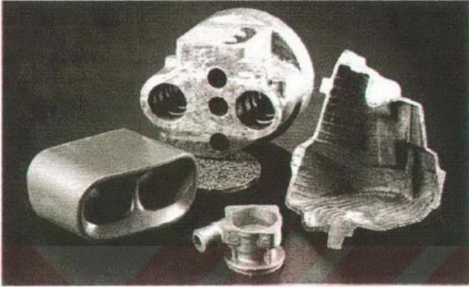
Resim 2.6. Toz metalurjisi yöntemi kullanılarak kalıp içerisine enjekte yolu ile elde edilmiş alüminyum köpük parçalar.
