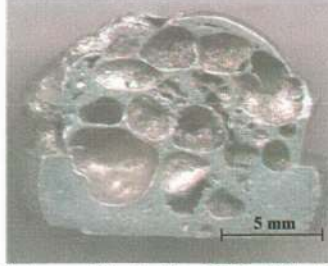
Resim 5.13. % 50 deforme edilerek elde edilmiş Al köpüğün gözenek yapısı.
