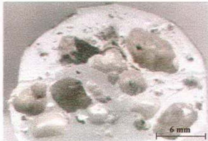
Resim 5.2. %1 TiH 2 ilave edilerek elde edilen metalik köpük
