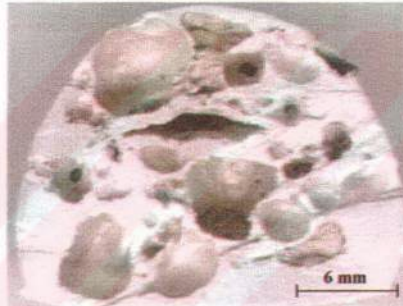
Resim 5.3. %1,5 TiH_2 ilave edilerek elde edilen metalik köpük.
