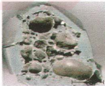
Resim 5.12. % 25 deforme edilerek elde edilmiş Al köpüğün gözenek yapısı.
