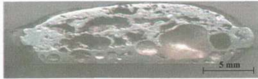
Resim 5.14. % 75 deforme edilerek elde edilmiş Al köpüğün gözenek yapısı.
