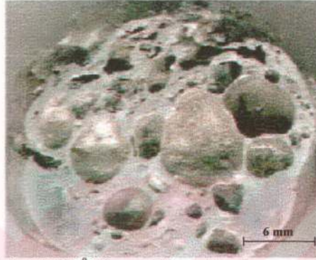
Resim 5.5. 700 °C fırın sıcaklığının gözenek yapısına etkisi
