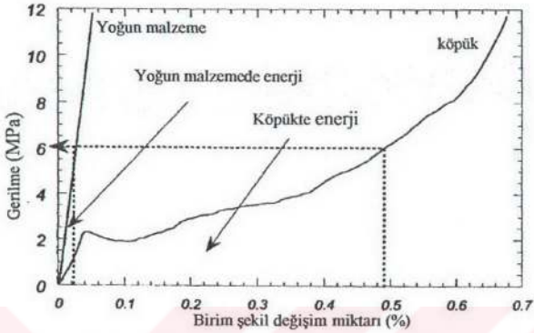
Şekil 3.8. Basma yüklemeleri altında Al köpük malzeme ile yoğun malzemenin enerji absorbeleri (1).
