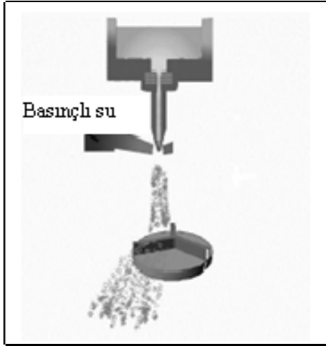
Şekil 2.10. Döner disk atomizasyon yöntemi .
