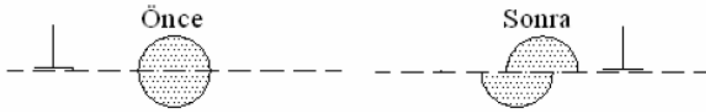
Şekil 2.28. Aşırı büyük çökeltilerin dislokasyonlar tarafından kesilmesi [36].
