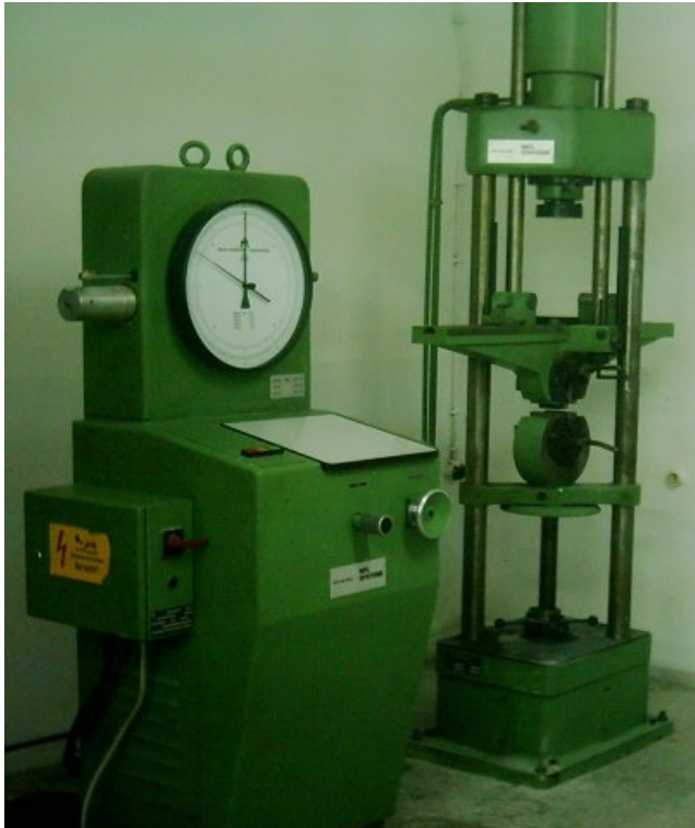
Resim 3.2. Deney numunelerinin preslendiği cihaz
