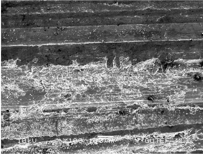
Resim 4.10. 600 °C’de 8 gün ısıtıl işlem uygulanmış numunenin aşınma yüzeyi
