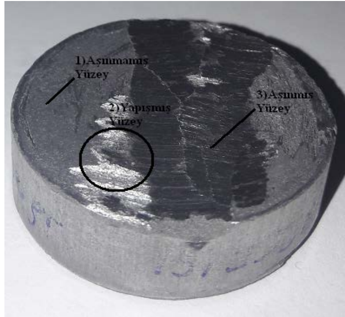
Şekil 4.23. B 4 C takviyeli Al matrisli kompozitin aşınmış görüntüsü
