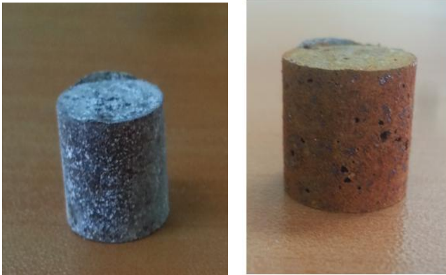
Şekil 5.4. Sinterlenmemiş gözenekli Fe numunenin ham (sol) ve üre uzaklaştırıldıktan sonra (sağ) fotoğrafları
