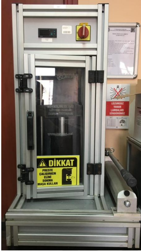
Şekil 4.5. Kullanılan tek eksenli hidrolik pres ve kalıplar
