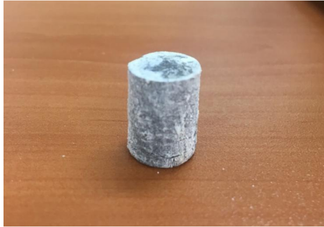
Şekil 5.44. Yapay vücut sıvısı (SBF) içerisinde 1 ay bekletilen Mg-Co alaşımlarının fotoğrafı
