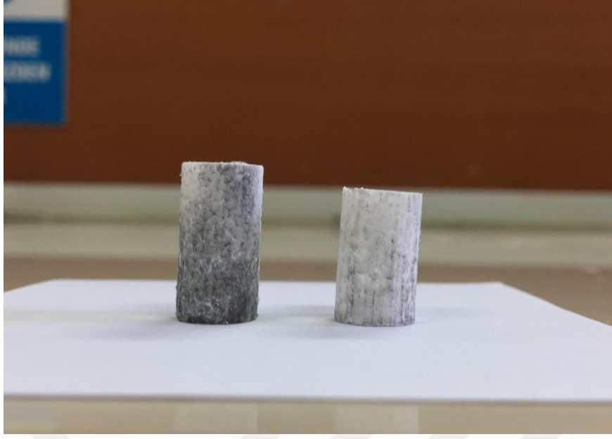
Şekil 5.5. Sinterlenmemiş gözenekli TCP numunelerinin fotoğrafı
