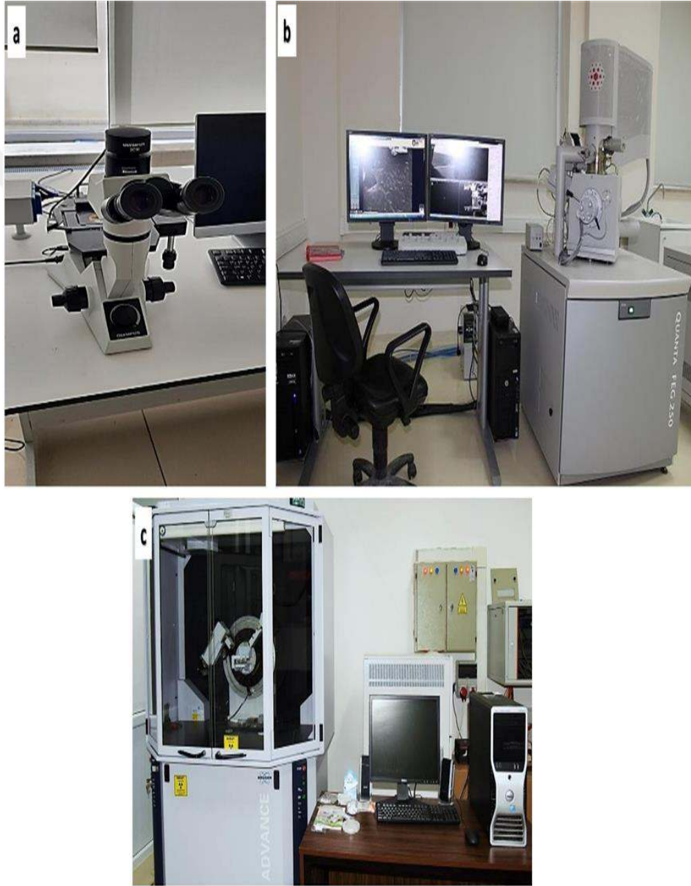
Şekil 4.8 Mikroyapı analizlerinde kullanılan cihazlar: (a) optik mikroskop cihazı, (b) SEM cihazı ve (c) XRD analiz cihazı
