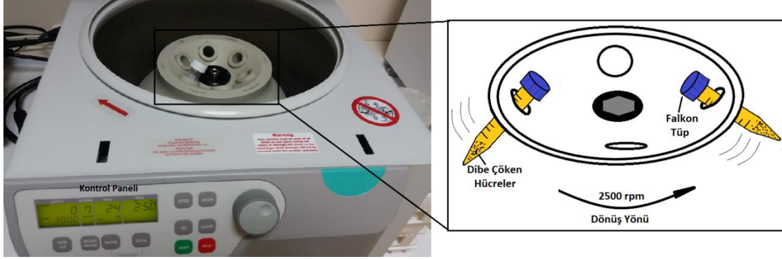
Şekil 3.9 Falcon tüp santrifüj cihazı ve şematik gösterimi.
