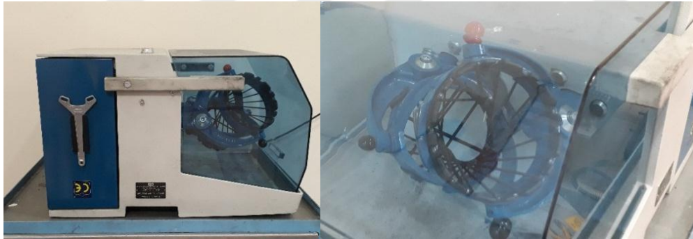
Resim 4.1. Turbula T2F tipi üç eksenli toz karıştırıcı
