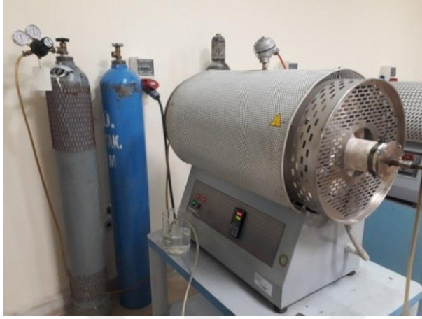
Resim 4.4. Geleneksel sinterleme işlemi için kullanılan tüp fırın fotoğrafı
