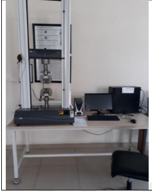
Resim 4.11. Çapraz kırılma dayanımı testlerinin gerçekleştirildiği test cihazı
