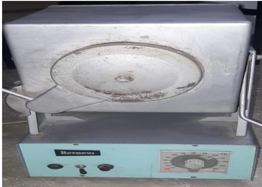
Şekil 7.2. Sinterleme işleminde kullanılan fırın
