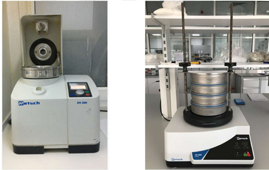
Şekil 3.9. Toz sorbitölün partikül boyut dağılımı için kullanılan laboratuvar tipi öğütücü ve elek seti
