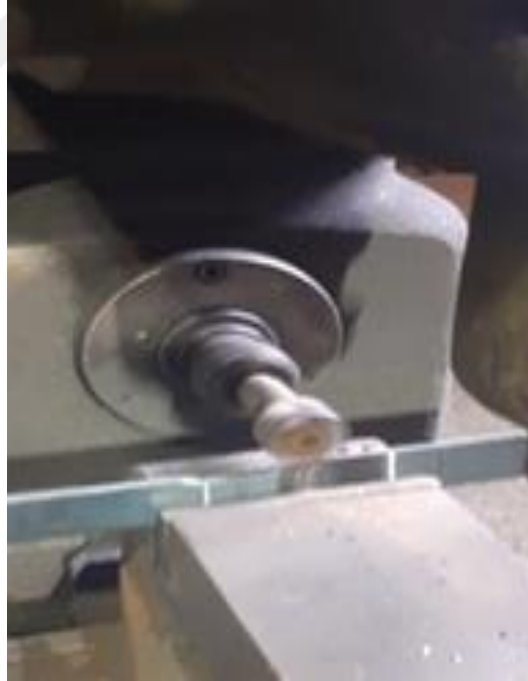
b) Kesilmiş numunelerden freze tezgâhında çekme numunesi hazırlanması
