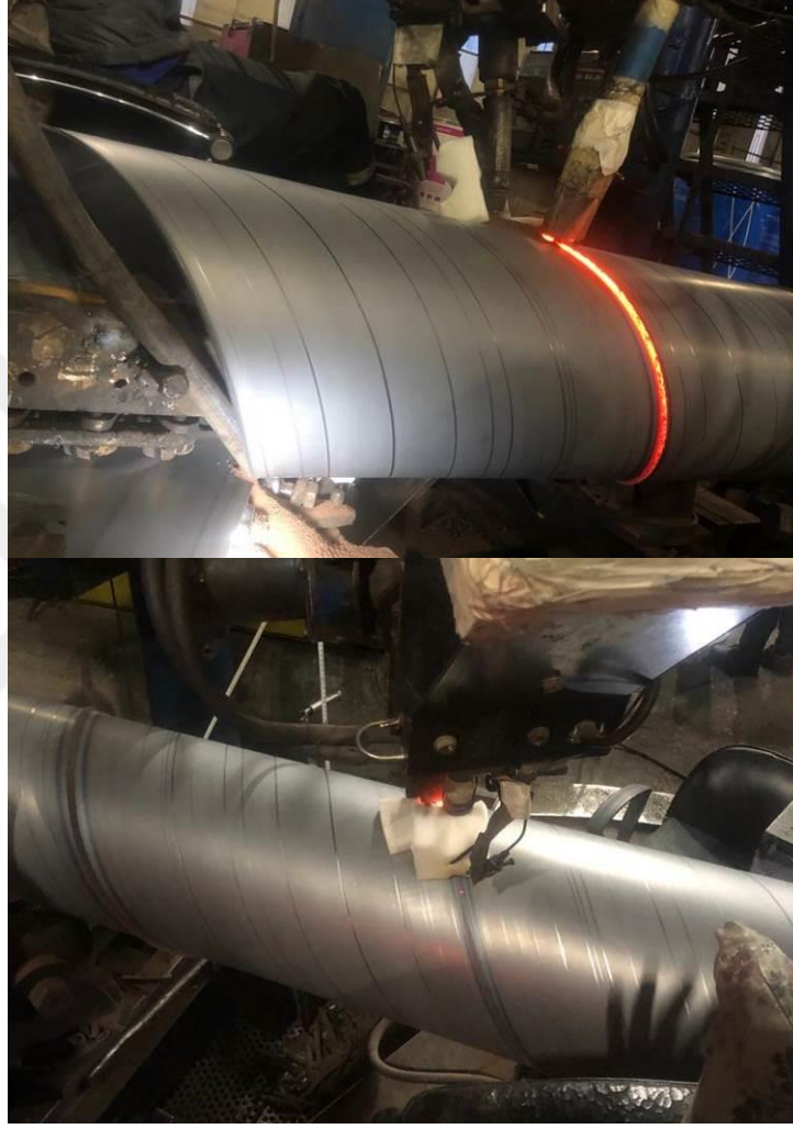
Şekil 3.1. Tozaltı kaynağıyla spiral boru üretimi
