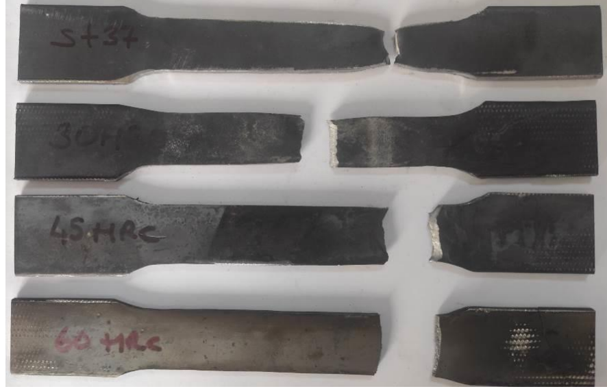
Şekil 4.4. Çekme testi sonucu kaynaksız ve sertleştirme ısı işlemi görmüş St37 çelik numunelerde kopma görüntüleri
