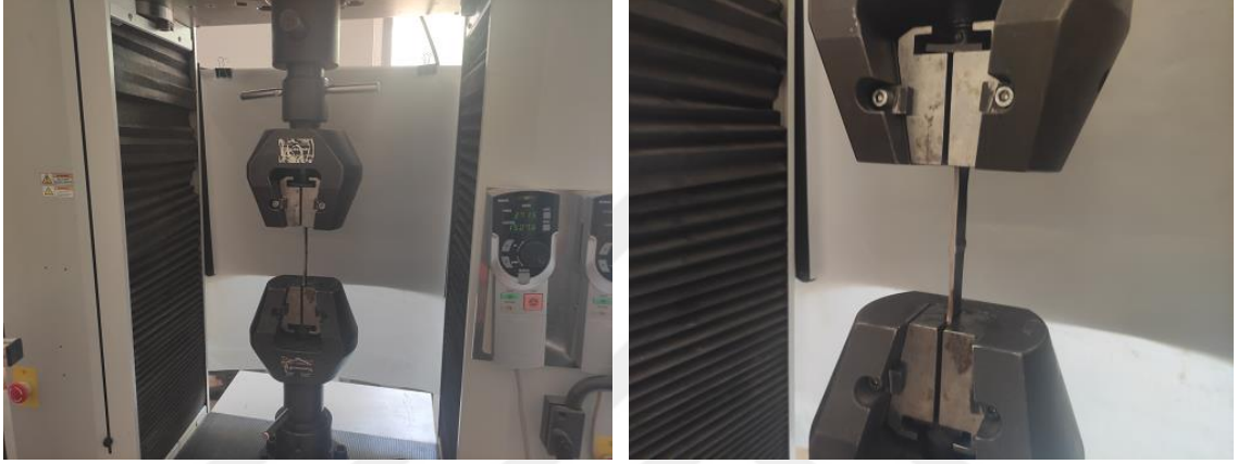
Şekil 3.7. Shimadzu marka çekme test cihazı
