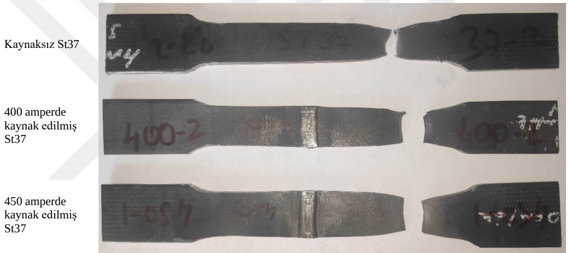
Şekil 4.2. Çekme testi sonucu kaynaksız (St37) ve 400-450 A akım değerlerinde kaynak edilmiş çelik numunelerde kopma görüntüleri
