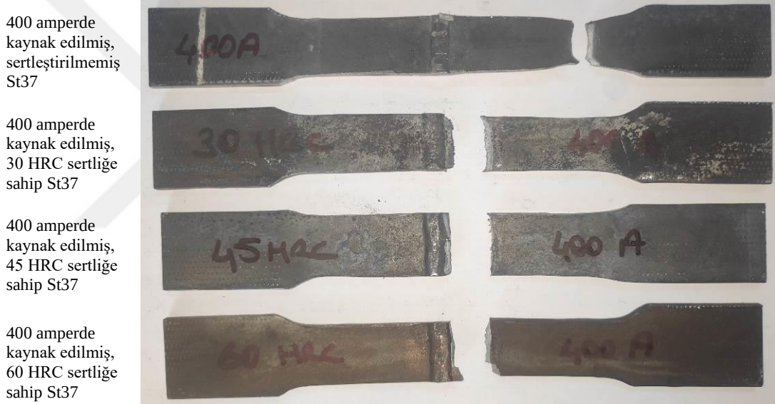
Şekil 4.6. Çekme testi sonucu 400 A akım değerinde birleştirilmiş ve sertleştirme ısı işlemi görmüş St37 çelik numunelerdeki kopma görüntüleri
