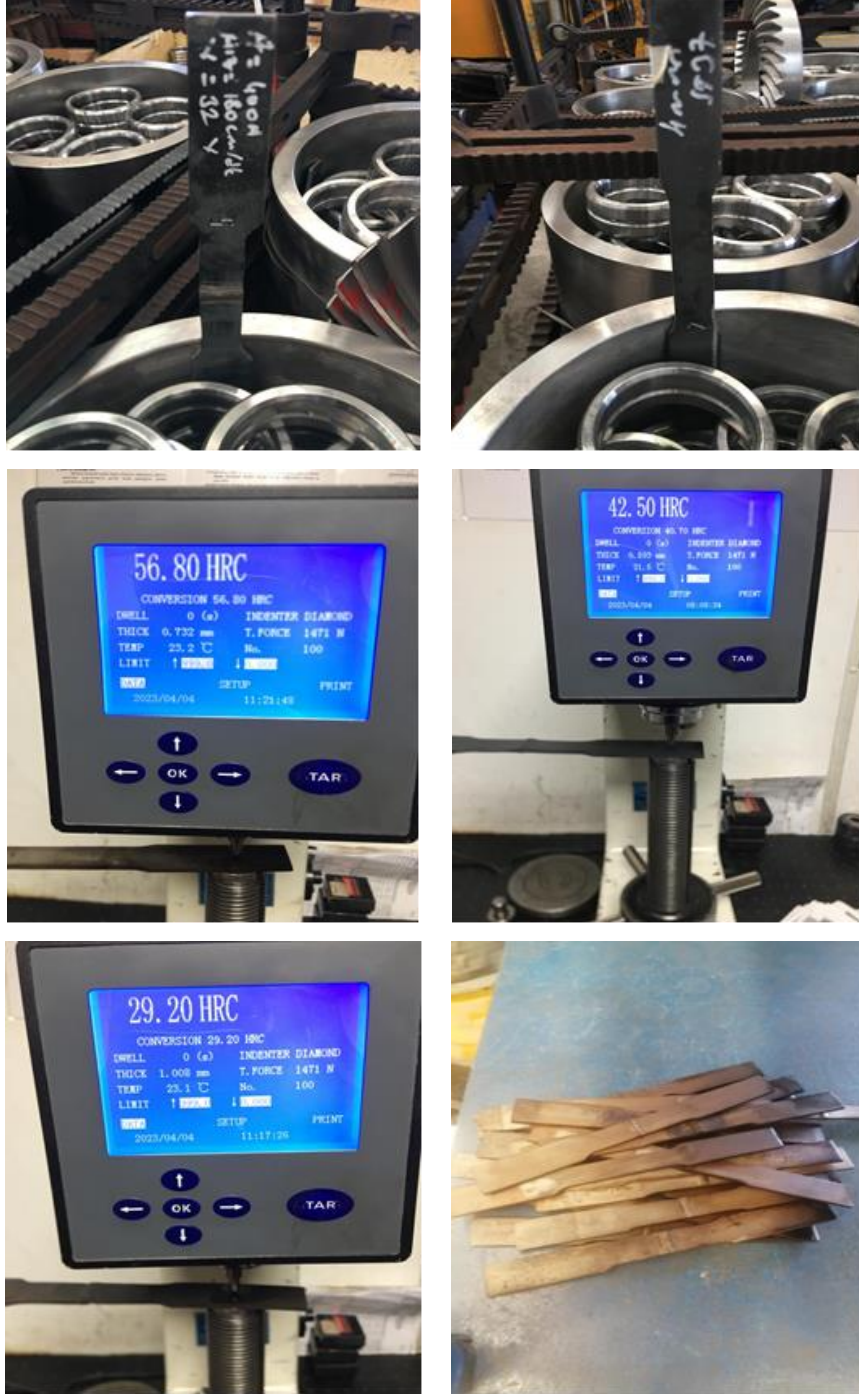
Şekil 3.6. Isıl işlem uygulaması ve sertlik ölçümüne ait görüntüler
