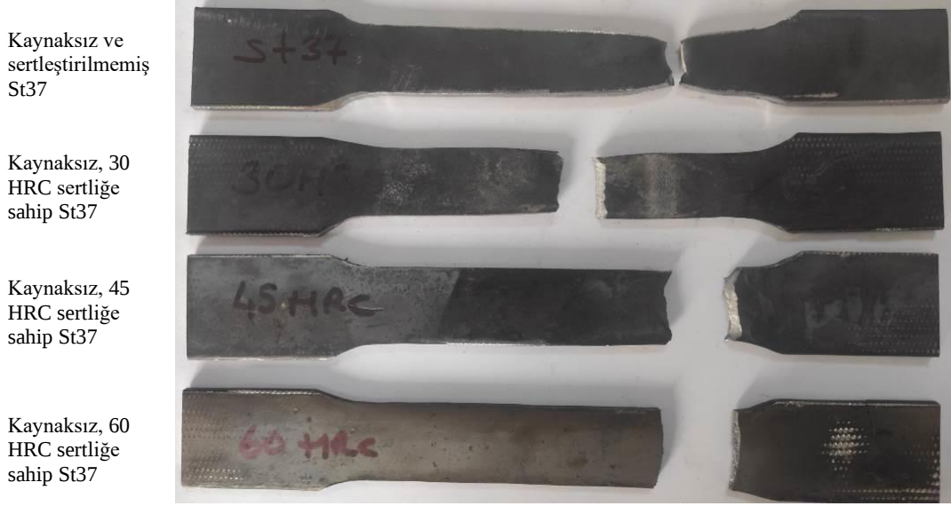
Şekil 4.4. Çekme testi sonucu kaynaksız ve sertleştirme ısı işlemi görmüş St37 çelik numunelerde kopma görüntüleri
