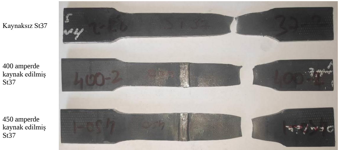
Şekil 4.2. Çekme testi sonucu kaynaksız (St37) ve 400-450 A akım değerlerinde kaynak edilmiş çelik numunelerdeki kopma görüntüleri
