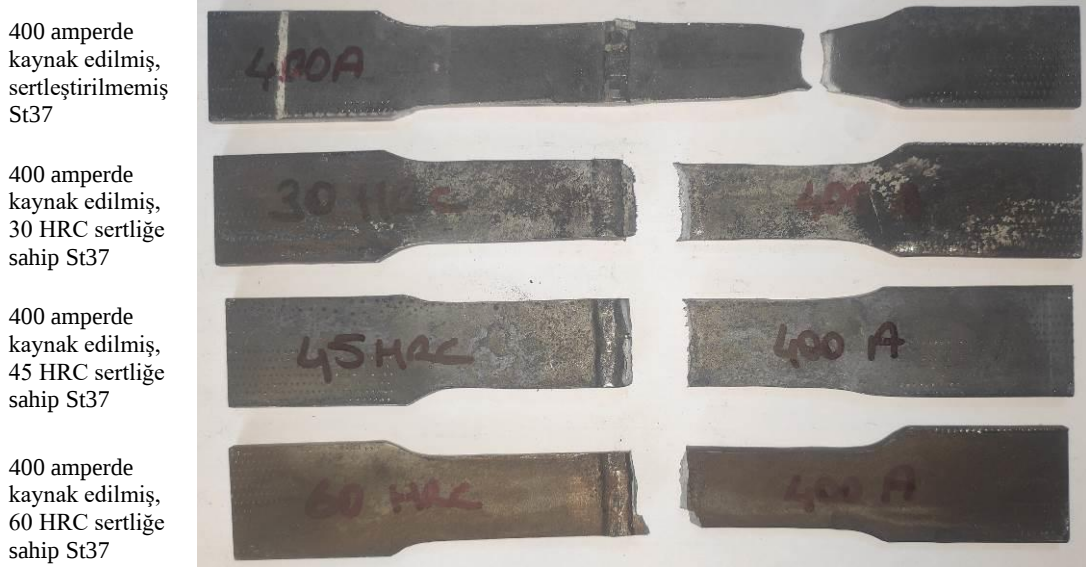
Şekil 4.6. Çekme testi sonucu 400 A akım değerinde birleştirilmiş ve sertleştirme ısı işlemi görmüş St37 çelik numunelerde kopma görüntüleri
