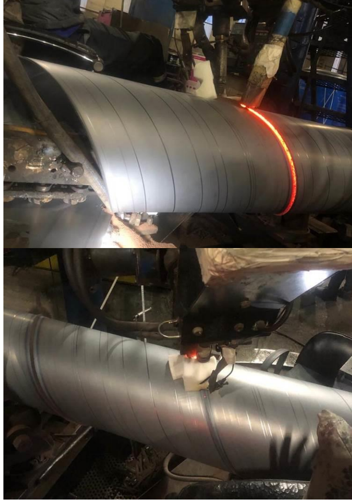
Şekil 3.1. Tozaltı kaynağıyla spiral boru üretimi
