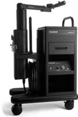
Resim 2.2. Birinci nesil cerrahi robot, AESOP
