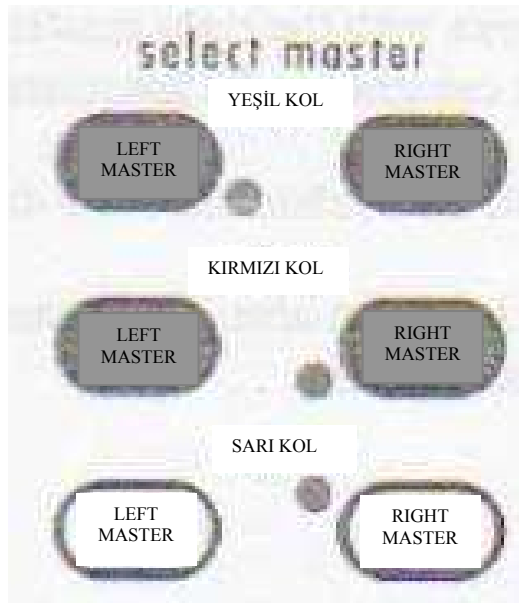
Şekil 3.6. Alet kollarını seçmek için ve sol veya sağ kontrol kolunu ayarlamak için kullanılan düğmeler
