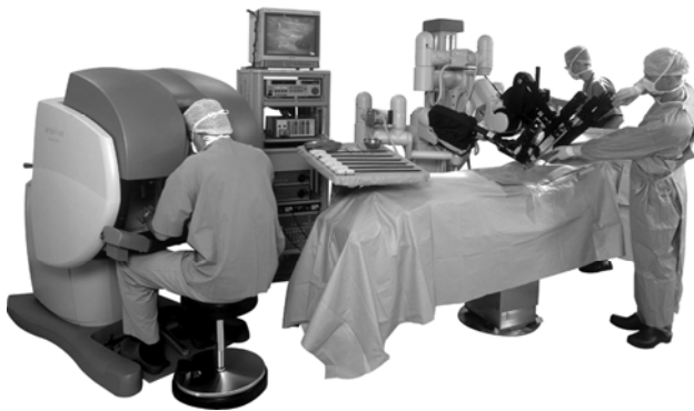
Resim 3.1. Soldan sağa, ana ünite, görüntüleme ünitesi, bağımlı ünite
