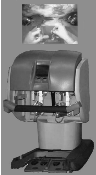
Resim 2.10. daVinci Sisteminin ana ünitesi, kontrol kolları, pedallar ve robot kollarındaki özel cerrahi enstrümanlar
