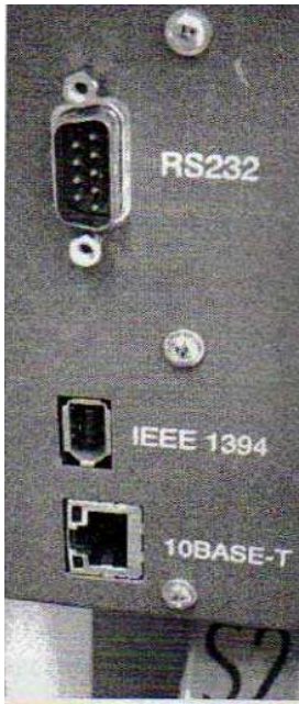
Resim 4.27. XCI harici bağlantıları
