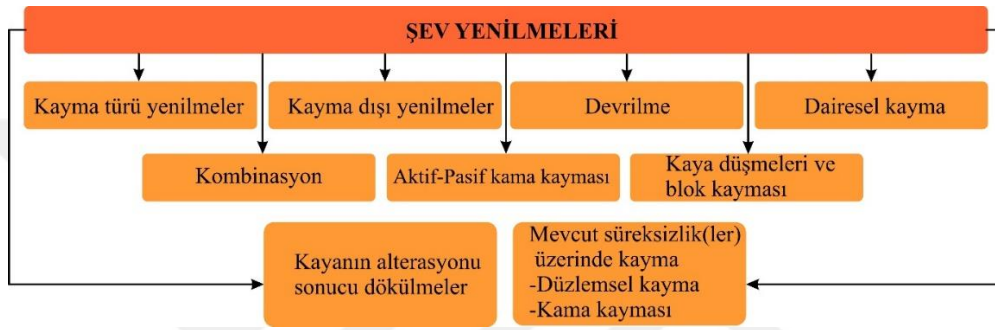
Şekil 7. Şev yenilme türlerinin sınıflandırılması (Eskikaya vd., 2005)
