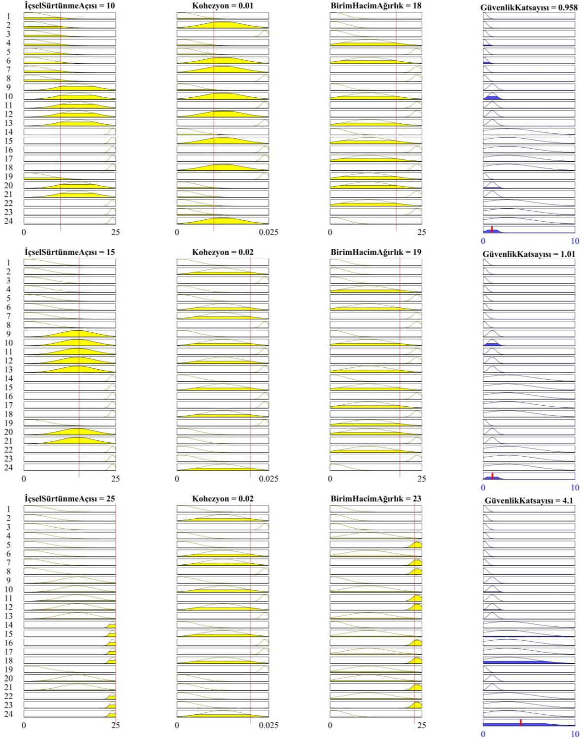
Şekil 65. Kil düzleminin a) en küçük, b) orta ve c) en yüksek içsel sürtünme, kohezyon ve birim hacim ağırlık parametrelerine göre bulanık çıkarım diyagramı (Gaussian üyelik fonksiyonu)
