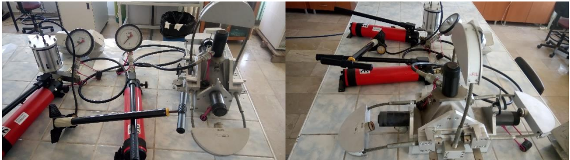
Şekil 38. Doğrudan kaya makaslama dayanımı cihazı
