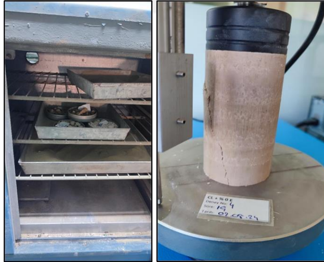
Şekil 68. Serbest basıncı deneyi ve sonrasında malzemelerin et ve konulması
