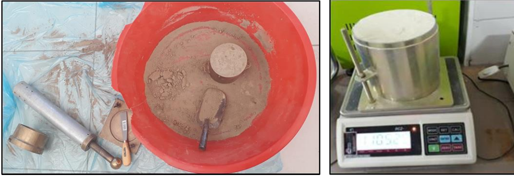
Şekil 57. Zeminin kalıba yerleştirilmesi ve tartılması
