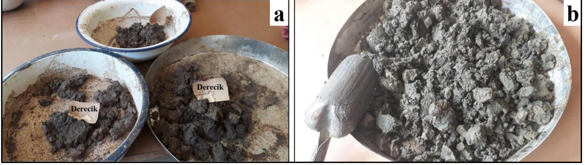
Şekil 40. Arıtma atık çamurlarının etüvden sonrası parçalanması ve hacim kaybı
