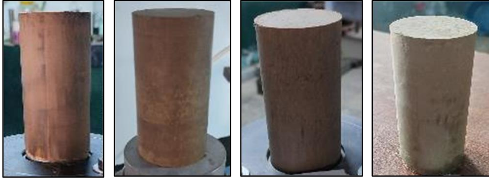
Şekil 60. Yarık silindirik çelik tüp seti ile hazırlanan numune örnekleri
