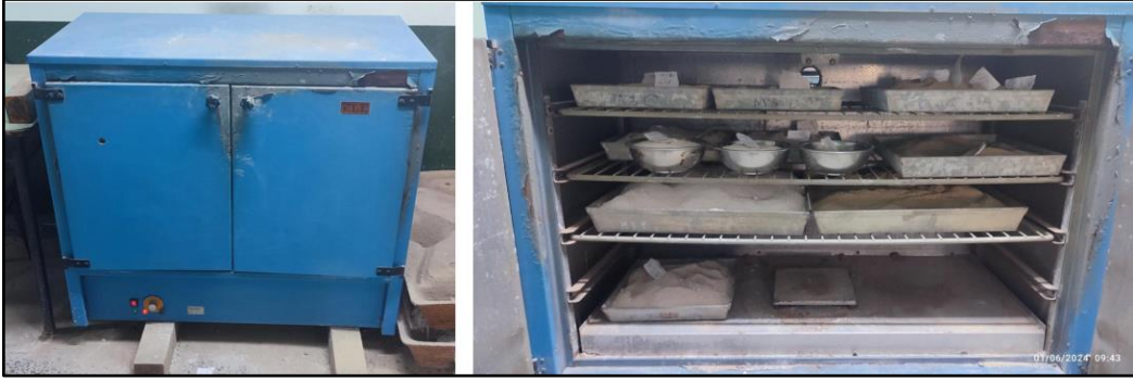
Şekil 63. Malzemelerin etüve konması
