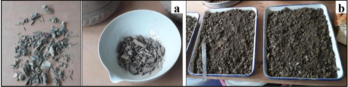
Şekil 41. Etüv sonrası atık çamuru içerisindeki yabancı malzemelerin ayıklanması
