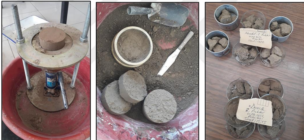
Şekil 58. Zeminin kalıptan çıkarılması ve su muhtevası tespiti
