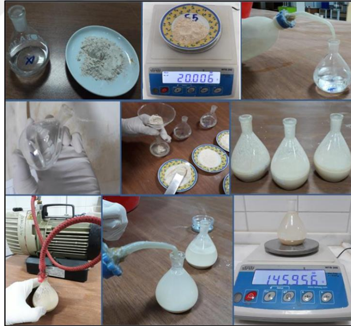
Şekil 55. Piknometre deneyi aşamaları
