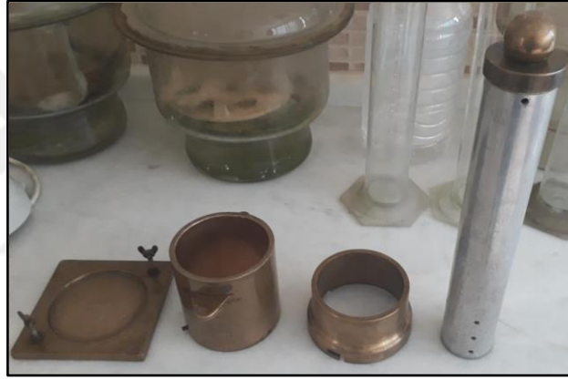
Şekil 56. Standart proktor deney aleti
