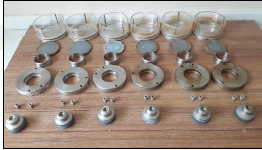
Şekil 50. Konsolidasyon halkası, poroz taşı, konsolidasyon hücresi
