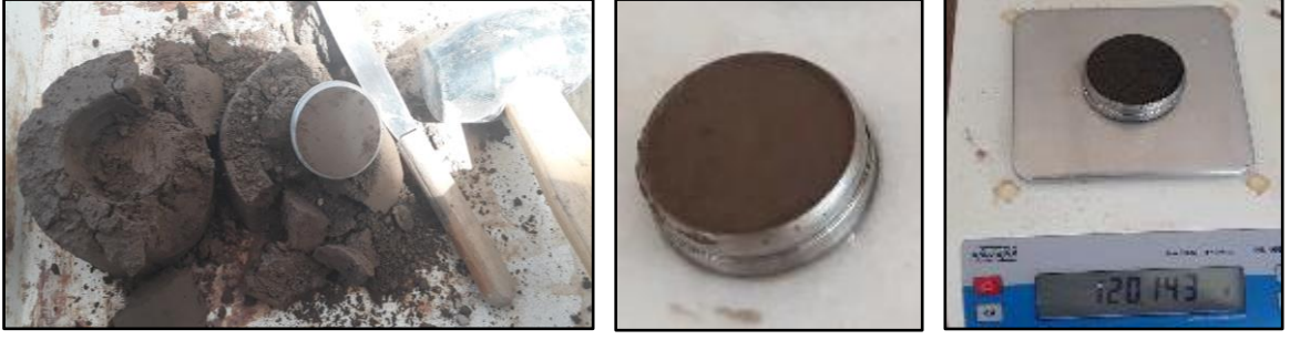
Şekil 51. Konsolidasyon deney numunesi hazırlaması
