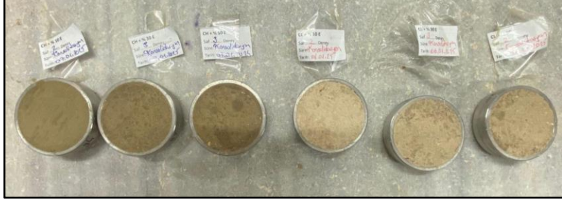
Şekil 64. Konsolidasyon halkasına numunelerin yerleştirilmesi
