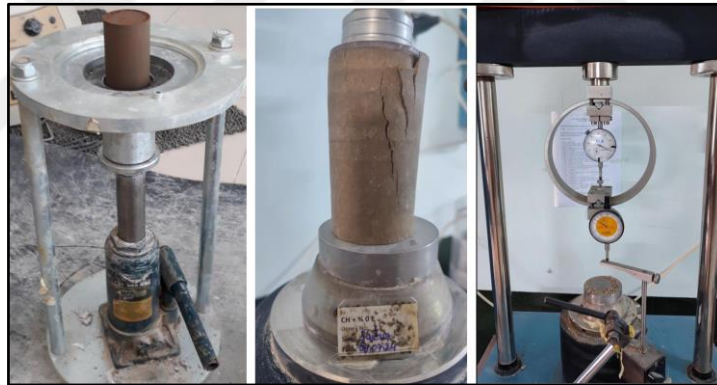
Şekil 61. Malzemenin kriko ile kalıptan çıkarılışı (a), Numunenin serbest basınç deney aletine yerleştirilmesi (b)
